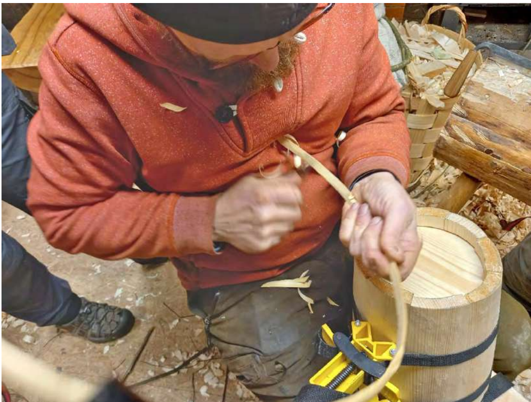
Joonis 10. Vitsa otste õhemaks vestmine.
