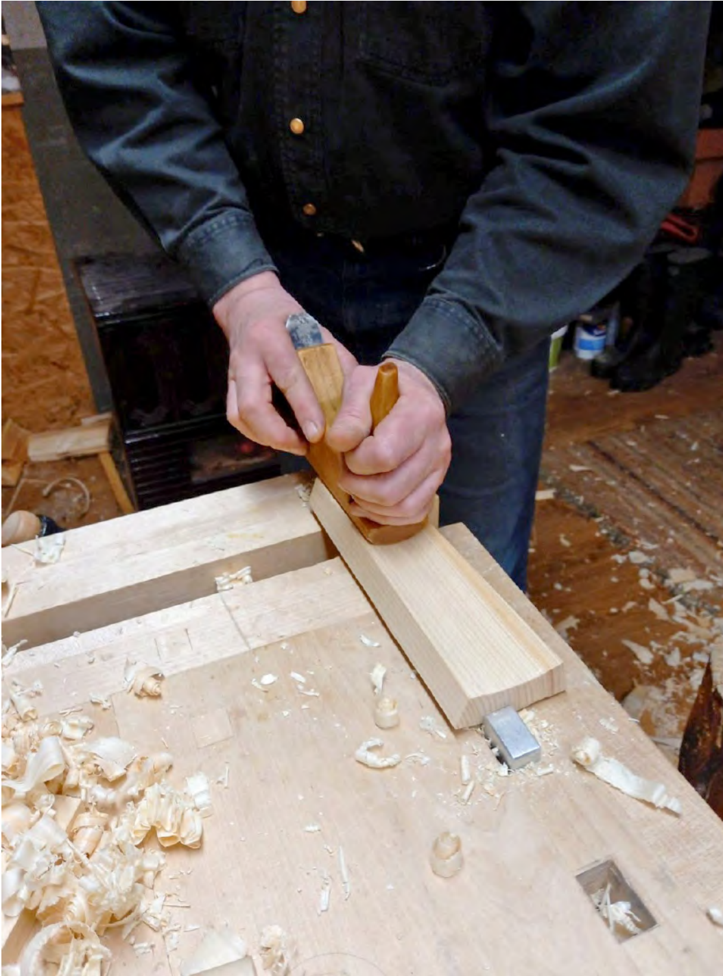
Joonis 1. Laudade sisepinna hõõveldamine kumerhöövliga.
