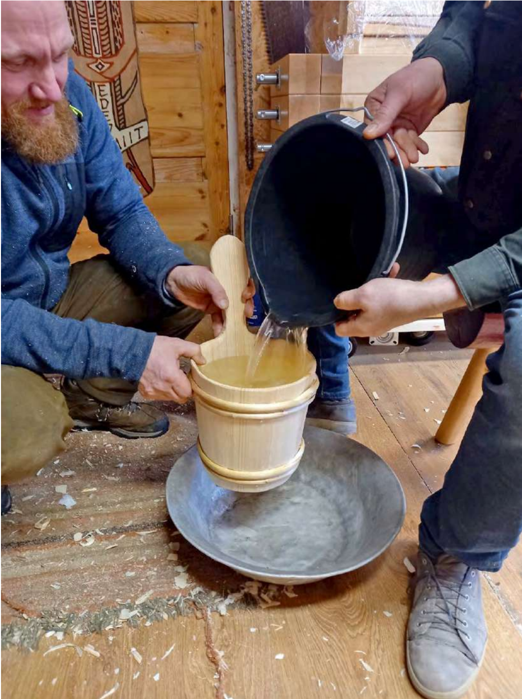
Joonis 19. Anuma vettpidavuse kontrollimine.
