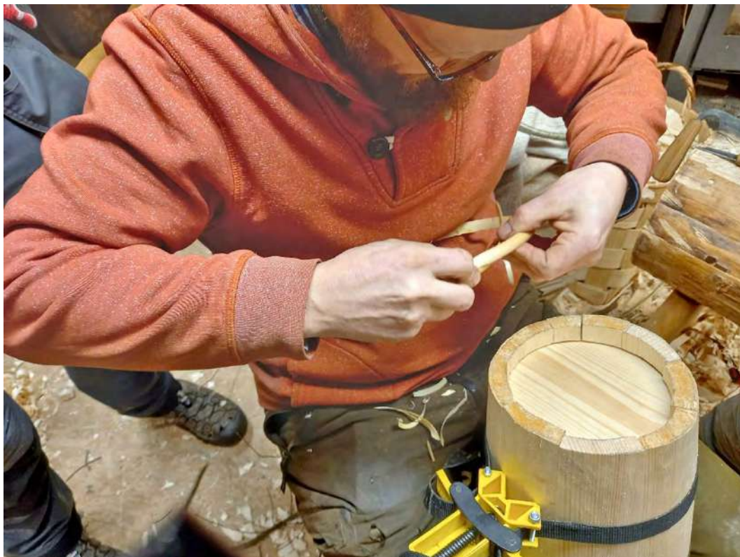
Joonis 11. Vitsa otste lukustamine.
