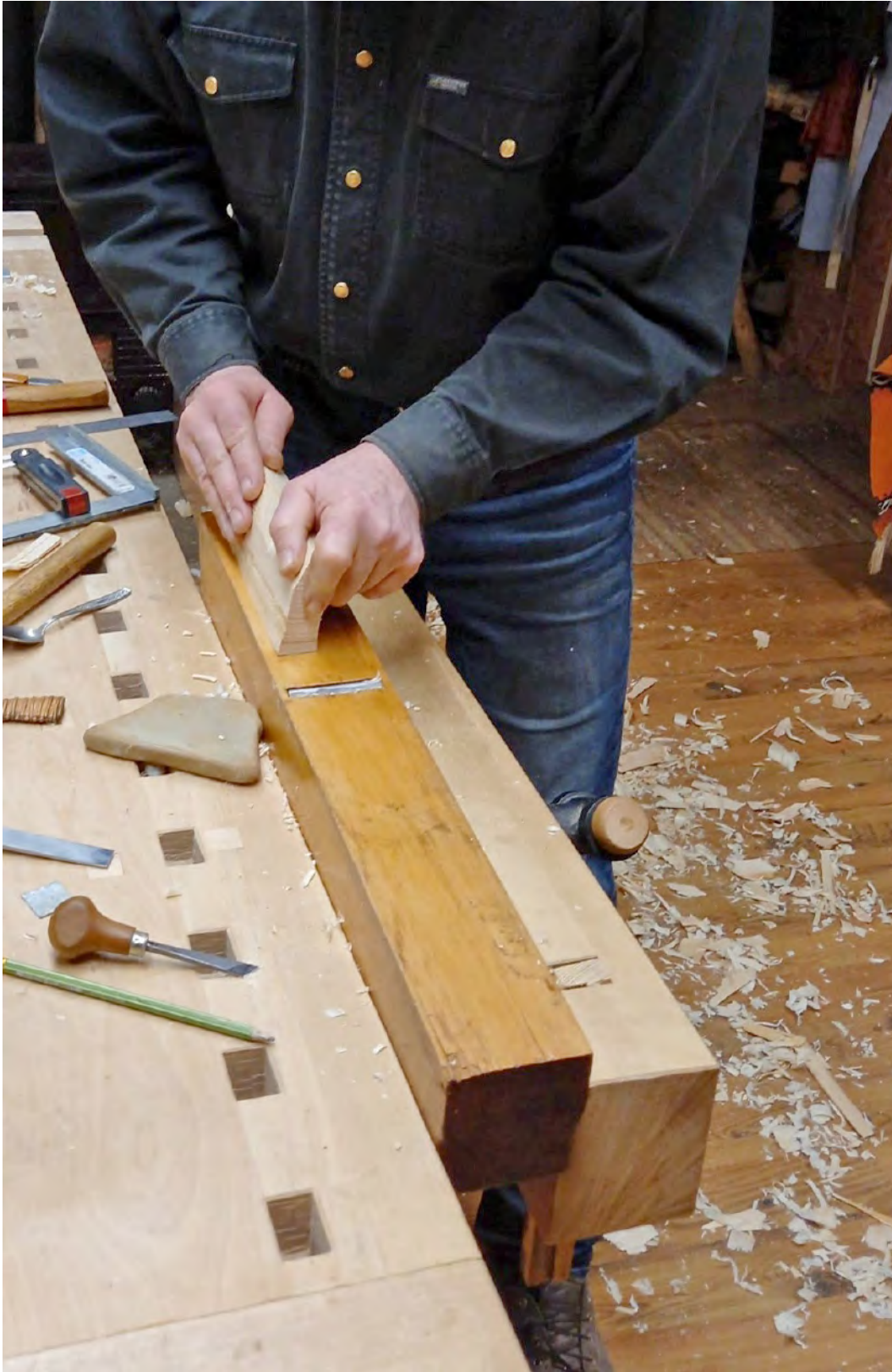
Joonis 2. Küljelaua servade hõõveldamine pikkhõövlil.
