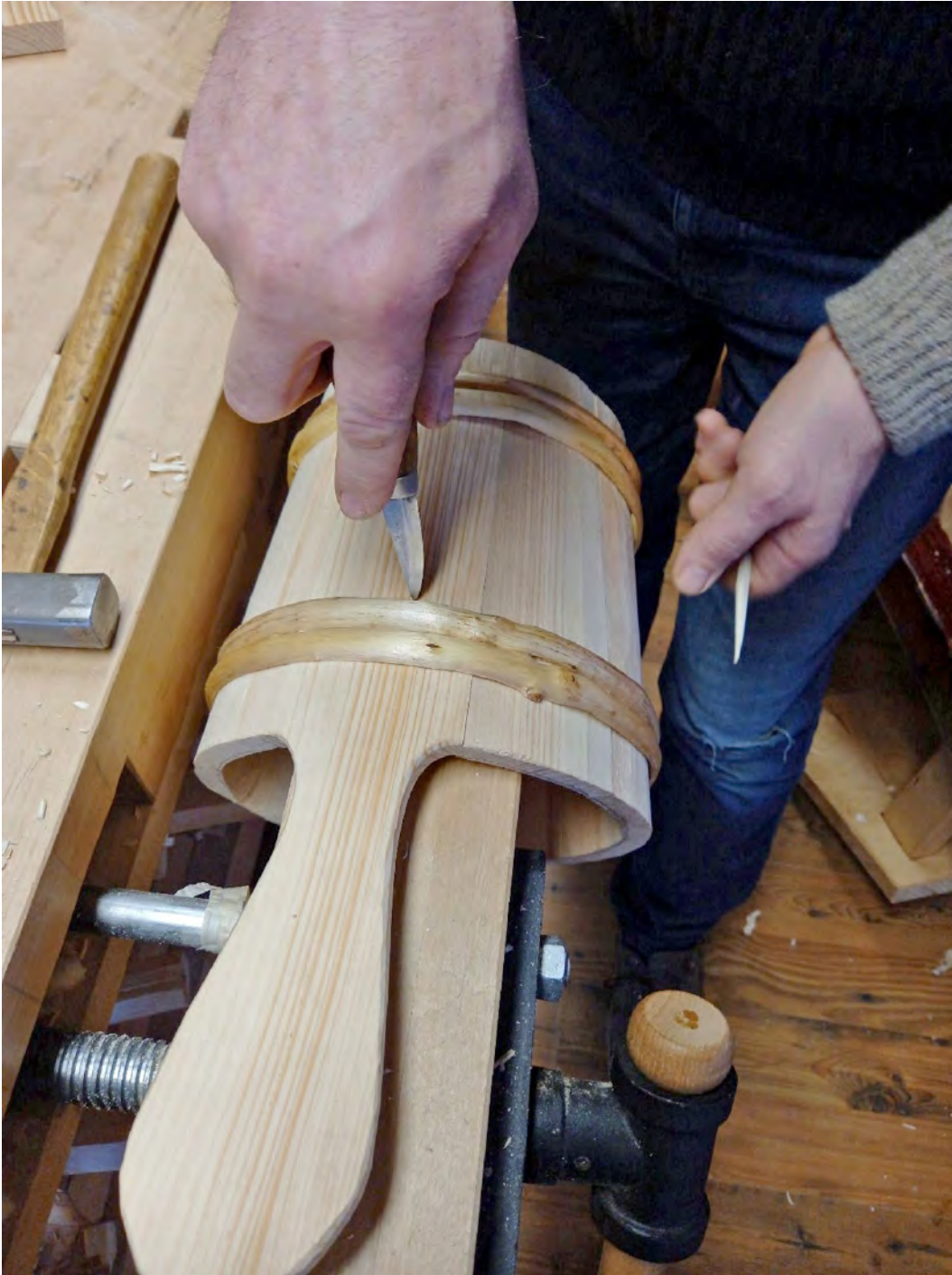
Joonis 15. Puunaelte jaoks avade puurimine noaga.
