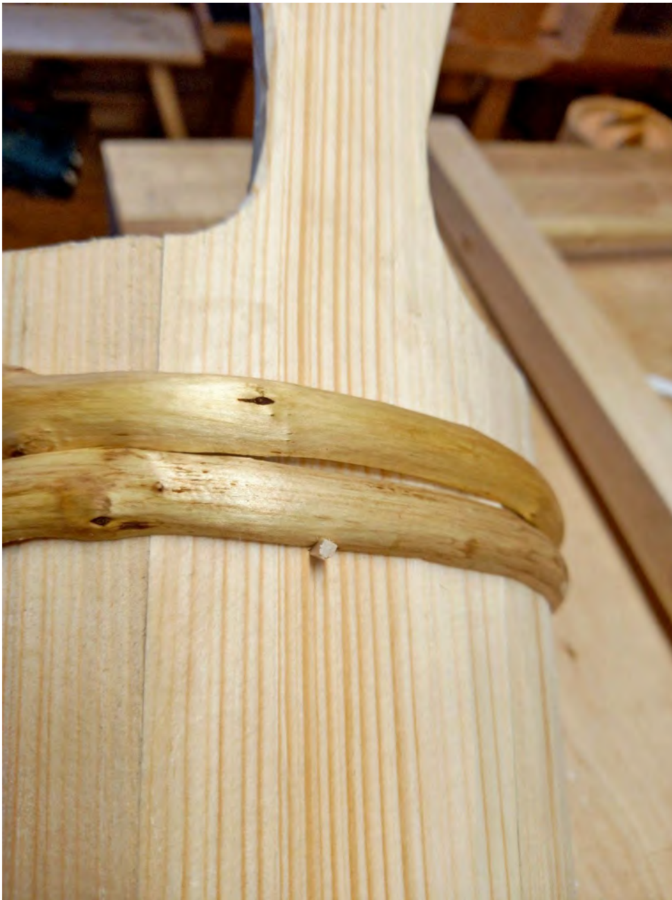
Joonis 16. Vitsade fikseerimine puunaeltega.
