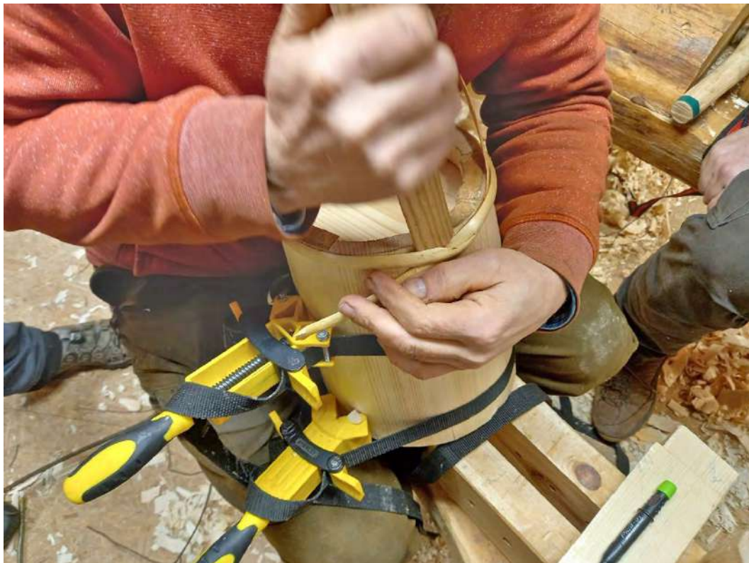
Joonis 12. Vitsa otste teineteise alla surumine kostipulgaga.
