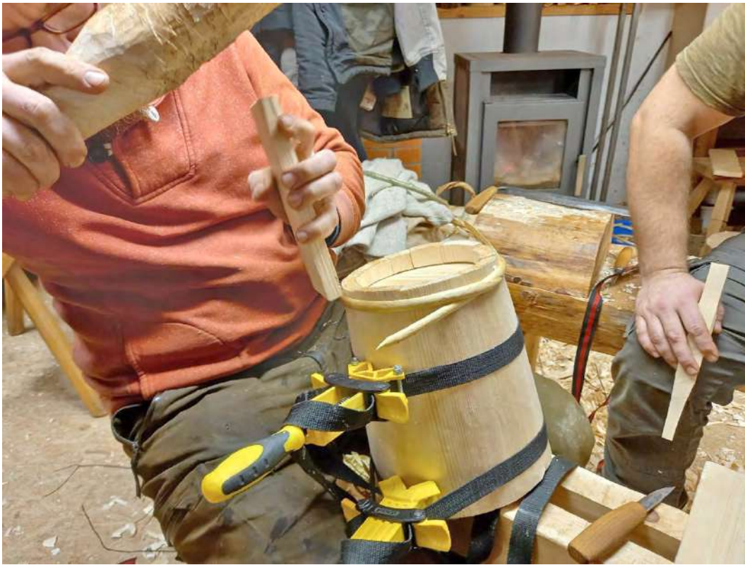
Joonis 13. Klotsiga vitsa omale kohale löömine.
