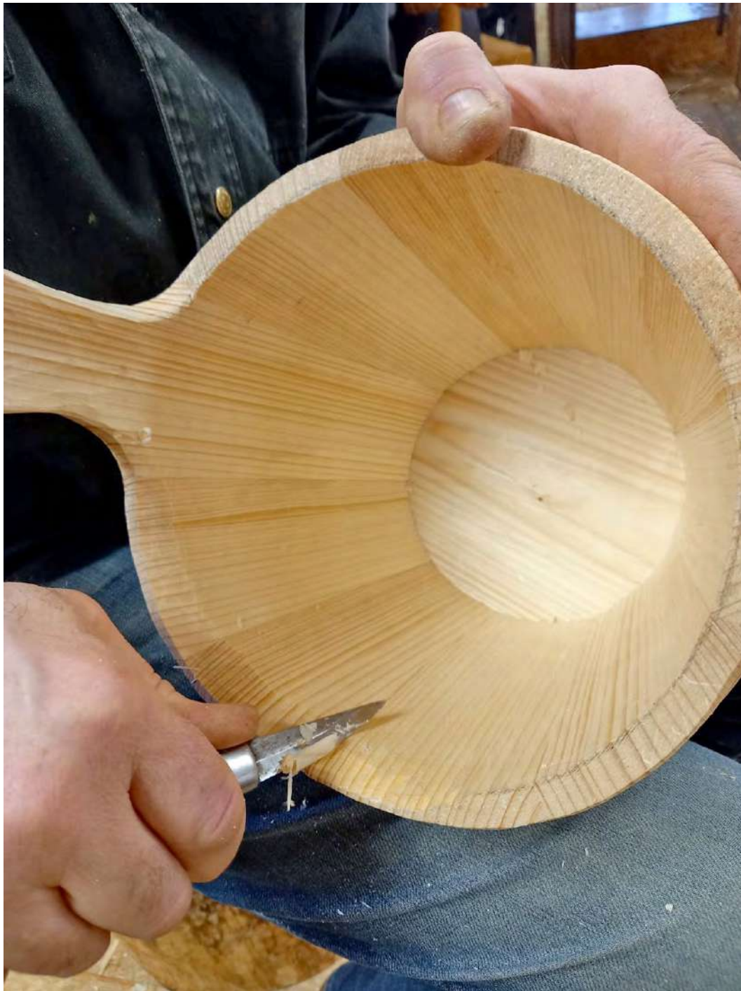
Joonis 18. Kibu ülaserva õhendamise ja pehmendamise.
