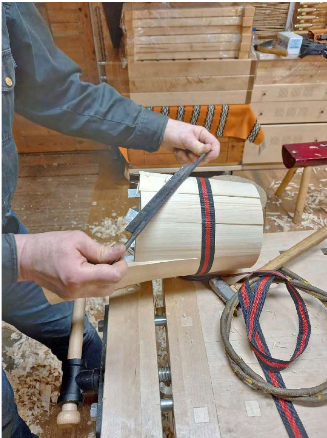
Joonis 5. Kibu välispinna tasandamine liimeistriga.
