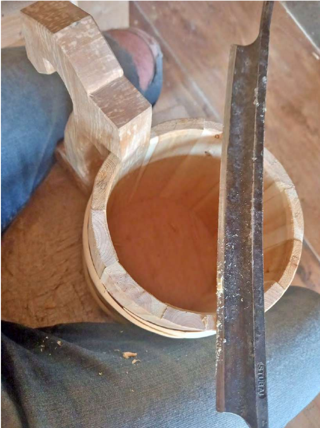
Joonis 14. Kannu otste tasandamine liimeistriga.
