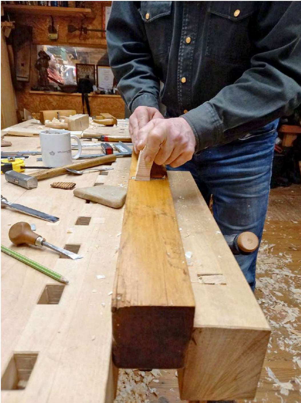
Joonis 3. Laua servade hõõveldamine pikkhõõvlil.
