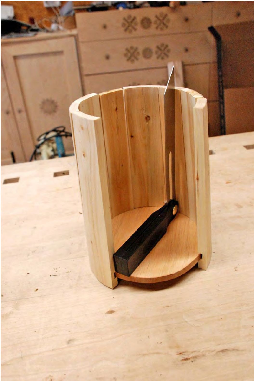
Joonis 7. Küljelaudade ja põhja vahelise nurga kontrollimine.
