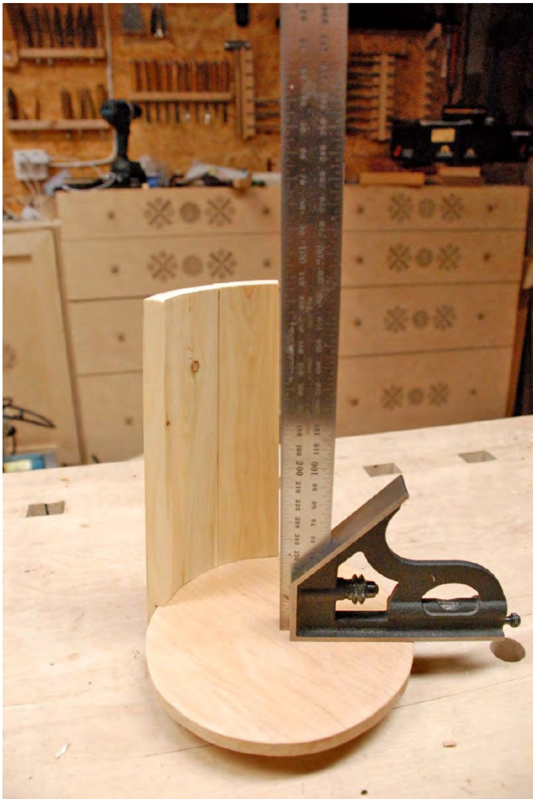
Joonis 6. Laua servade ja kannu telje paralleelsuse kontrollimine.
