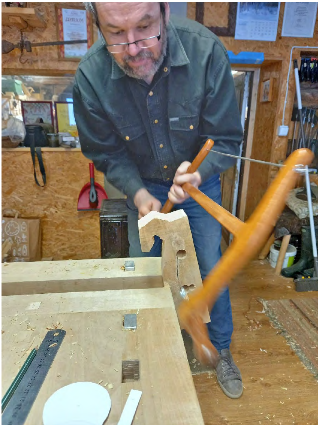
Joonis 10. Käepideme väljasaagimine.
