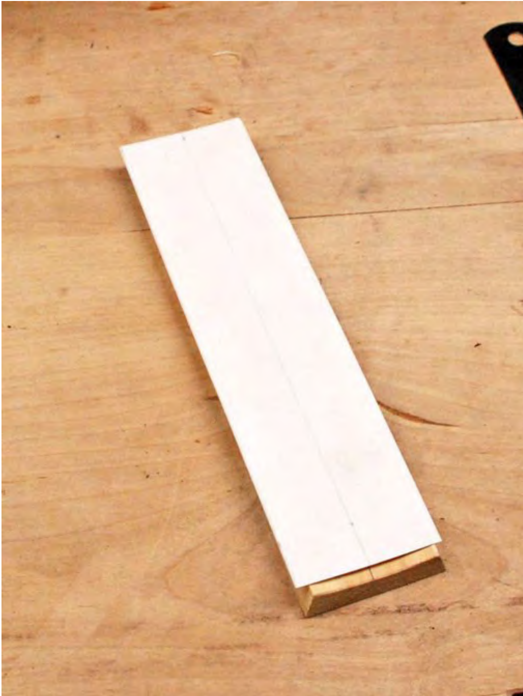
Joonis 4. Laua otste saagimisjoonte märkimine.
