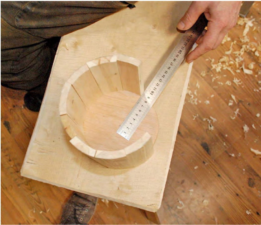
Joonis 8. Servade koondumise kontrollimine anuma tsesntrisse.
