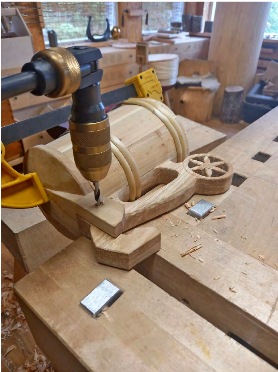
Joonis 16. Tüübliava puurimine.
