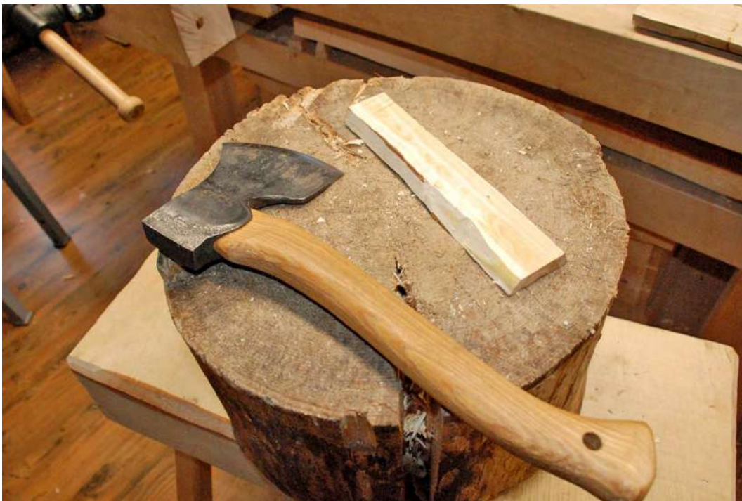
Joonis 1. Küljelaua toorikute tahumine.
