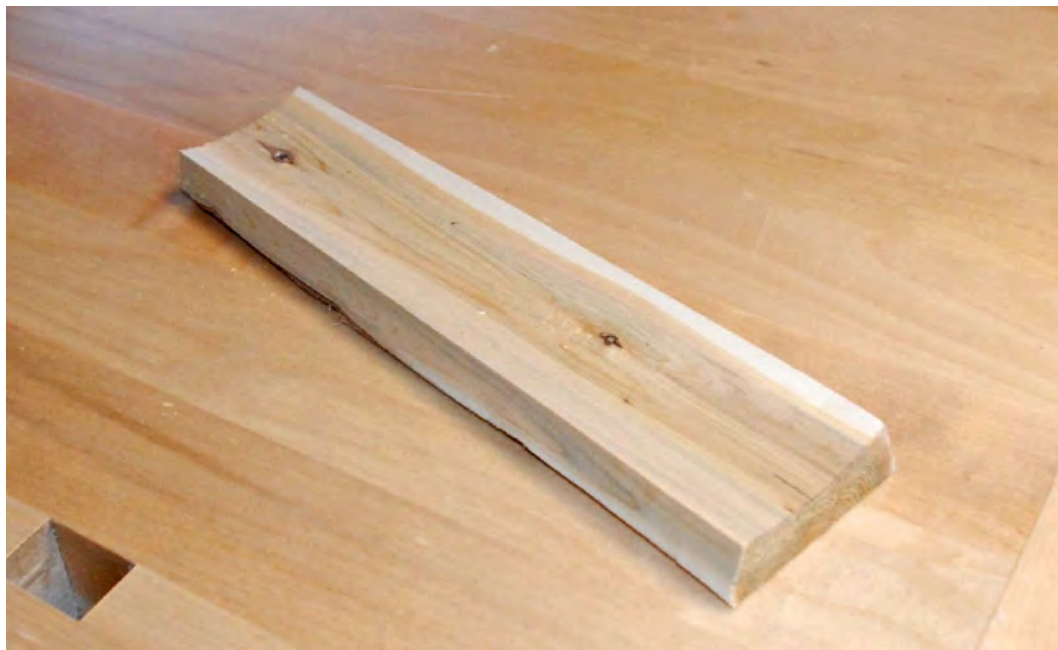
Joonis 2. Küljelaua sisepinna hõõveldamine.
